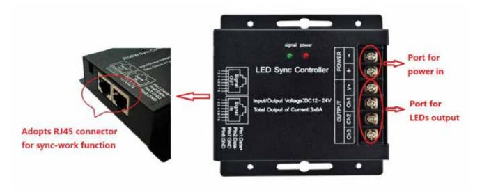
RGB Connection:  $V+\rightarrow COM$ ,  $CH1\rightarrow R$ ,  $CH2\rightarrow G$ ,  $CH3\rightarrow B$ .
